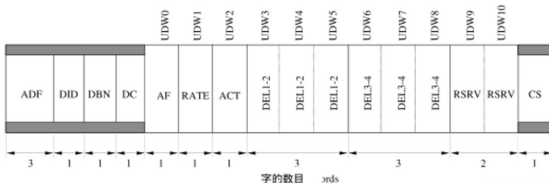
图 7 音频控制包结构
